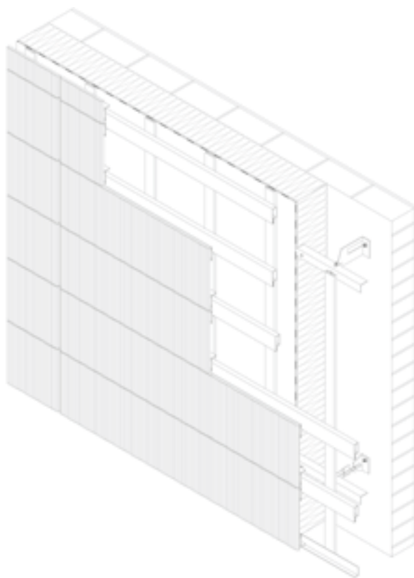
ISOMETRIA CASA DI ABITAZIONE SOLARIS, ZURIGO Rappresentazione schematica Fonte: www.buk.arch.ethz.ch/Solardatenbank
