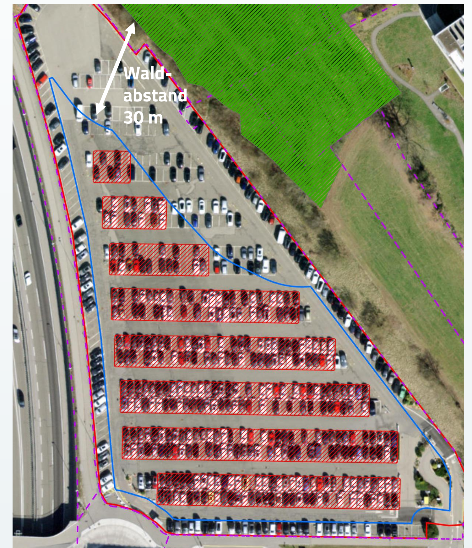
Abbildung 3: Beispiel der Ermittlung von PV-Flächen auf Parkplatzarealen unter Berücksichtigung von baurechtlichen Abständen zur Grundstücksgrenze und 30m zum Wald (blaue Linie) und einer Modulbelegung für PV Carports (rote Flächen).
